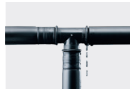
Definierte Leckagepfade machen nicht verpresste Fittings bei der Druckprüfung sofort sichtbar.
