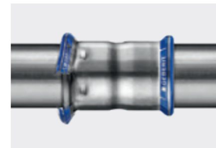
Farbige Indikatoren zeigen nicht verpresste Mapress Fittings schon vor dem Drucktest.
