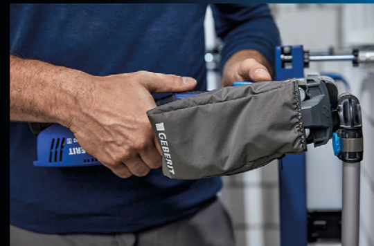
Beim Verpressen mit dem Auffangbeutel werden die Pressindikatoren direkt gesammelt und können so einfach entsorgt werden.
