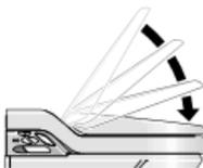
Dämpfer federn WC-Sitz und WC-Deckel geräuschlos ab und sorgen für ein langsames Schliessen. Das Öffnen funktioniert wie bei einem normalen WC-Sitz und WC-Deckel.
