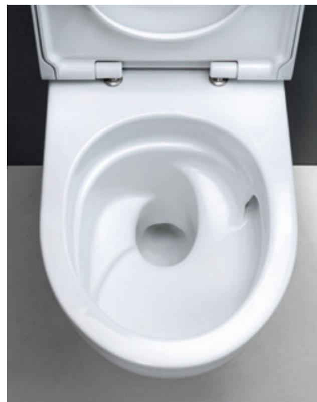
Die asymmetrische Keramikform versetzt den kräftigen Spülstrom aus dem Geberit Spülkasten in eine rotierende Bewegung. Das WC wird vollflächig, besonders gründlich und leise ausgespült.
