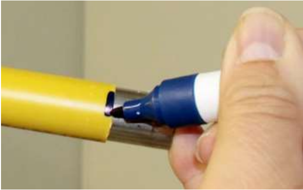
Bild 13: Markierung der Einstecktiefe bei Verwendung von Mapress Abmantelgerät
