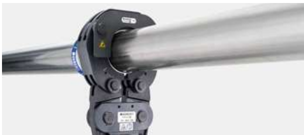
Bild 19: Pressvorgang mit Pressschlinge d_a 42 – 108 mm
