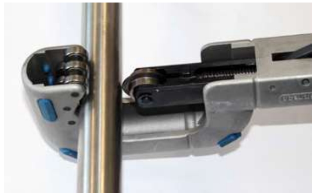
Bild 6: Ablängen mit Rohrschneider
